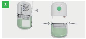
Lösen Sie die Schläuche an der Rückseite der Pumpe. Drücken Sie kräftig auf die seitlichen Laschen und ziehen Sie mit leichtem Ruckeln, um den Kanister zu trennen. Bringen Sie den neuen Kanister an. Sie können damit rechnen, dass der Kanister sehr fest sitzt. Das ist normal und notwendig, um eine wirksame Dichtung aufrechtzuerhalten.
