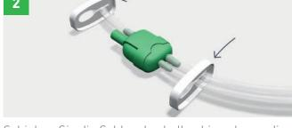
Schieben Sie die Schlauchschellen bis nahe an die grünen Anschlüsse und drücken Sie beide Schellen über die Schläuche, um sicherzustellen, dass es beim Trennen nicht zu einer Undichtigkeit kommt.
